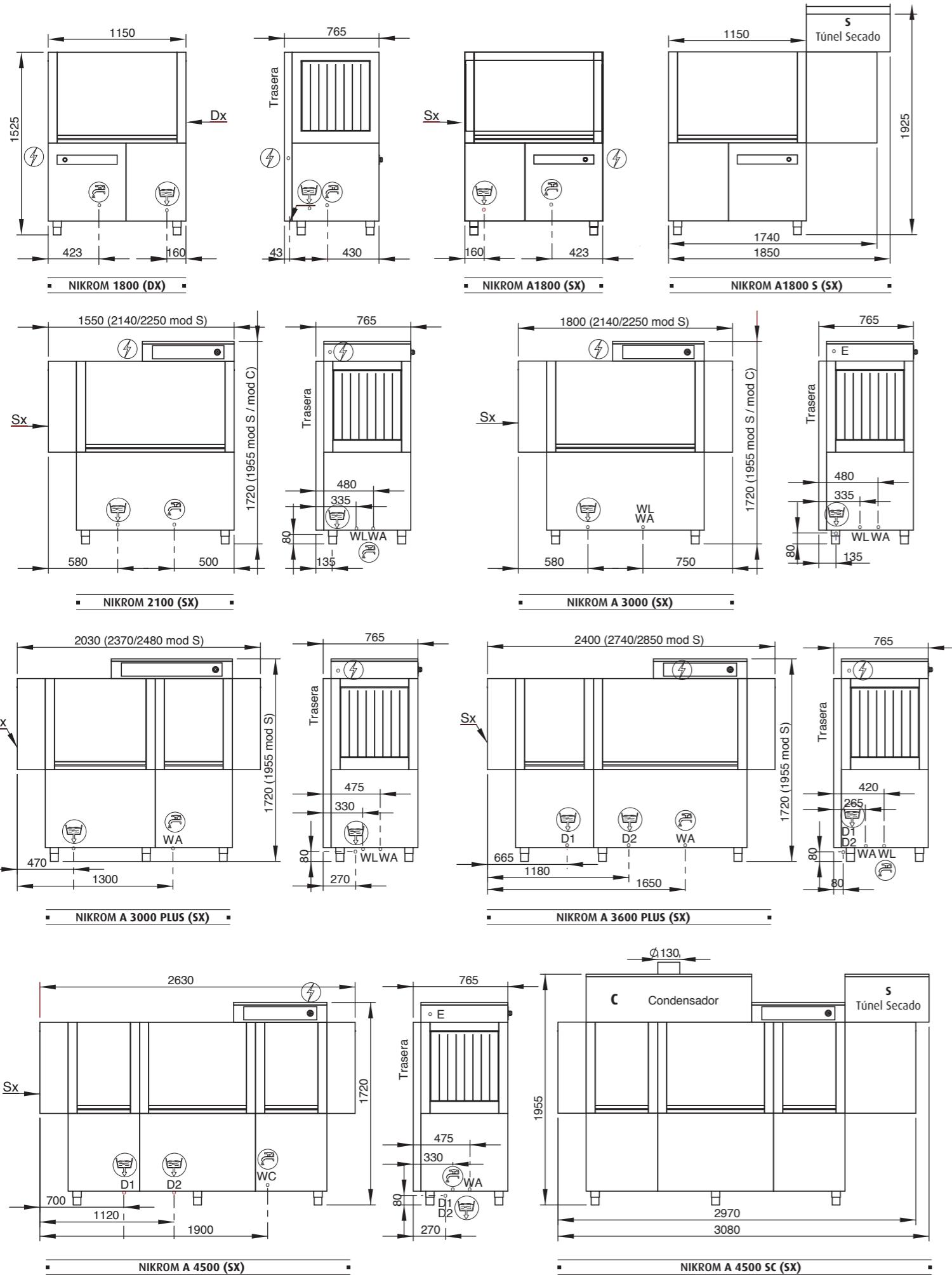
W = Conexión Hidráulica 3/4"
